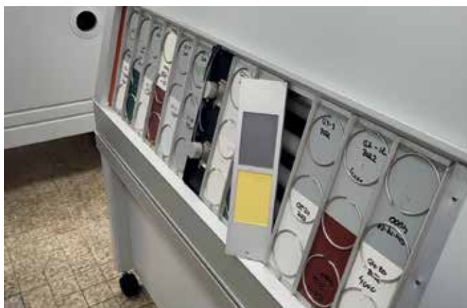
Laboratoriumapparatuur om UV-bestendigheid te testen
