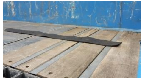
Leg eerst anti-slip materiaal, bij voorkeur ook tussen de pakketten
