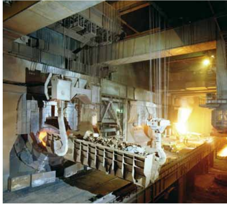
9.3b Gerecycleerd staal als schrootinzet bij een converter. Op dit moment wordt zo'n 70% van al het gebruikte staal in gevels en daken gerecycleerd tot nieuw staal met minimaal gelijke kwaliteit.
