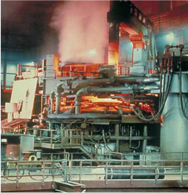
9.3a Een electro-oven gebruikt 100% gerecycleerd staal.
